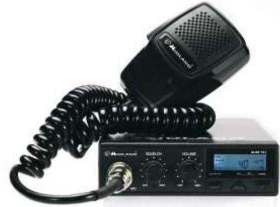
Il baracchino è un apparecchio radio ricetrasmittente, solitamente usato a bordo di autoveicoli per scopo dilettantistico, quindi non professionale, e utilizzabile in un raggio d'azione medio-corto.
